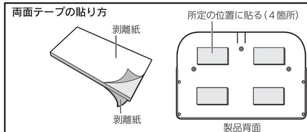
壁面に凹凸がなく、剥がれやすい塗装および壁紙などの処理がされていない場合は付属の両面テープ(4枚)のみで設置することができます。
