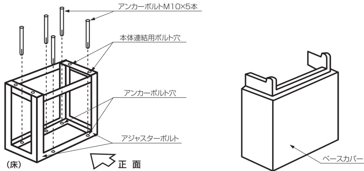
3. ベースフレームをアンカーボルト穴位置に合わせて、強固に固定する。
