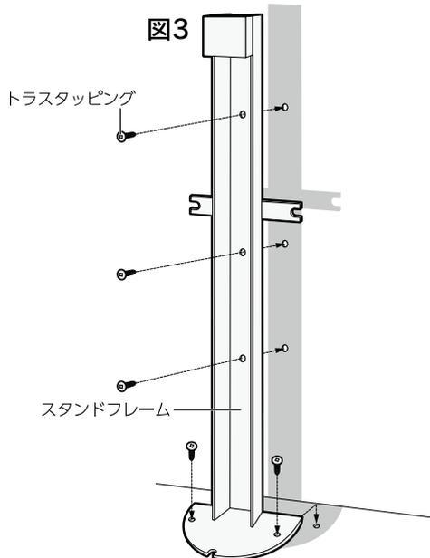
平面壁に設置する場合の施工方法
